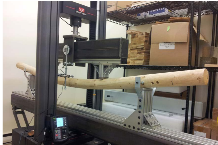
Essai statique de flexion 4 points
